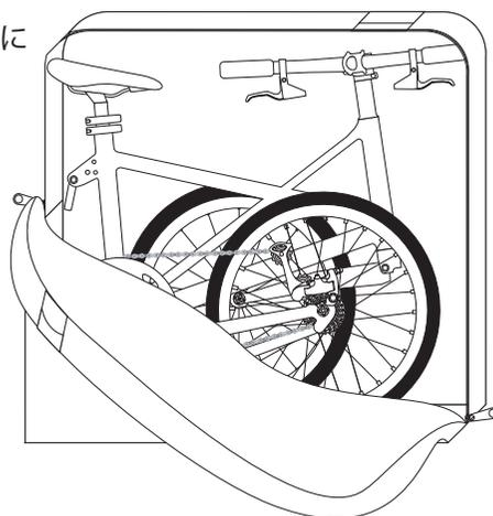
2. 輪行バッグのスリットにショルダーベルトを通し、図の位置でフレームに固定します。
