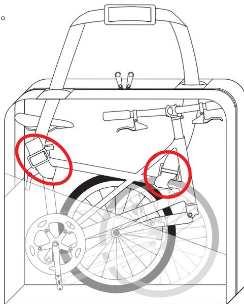
3. ショルダーベルトを肩にかけます。ベルトの長さを調節して高い位置で担ぐと、階段などが移動しやすくなります。持ち運びの際は落下防止のため、フレームの一部をつかんでください。
